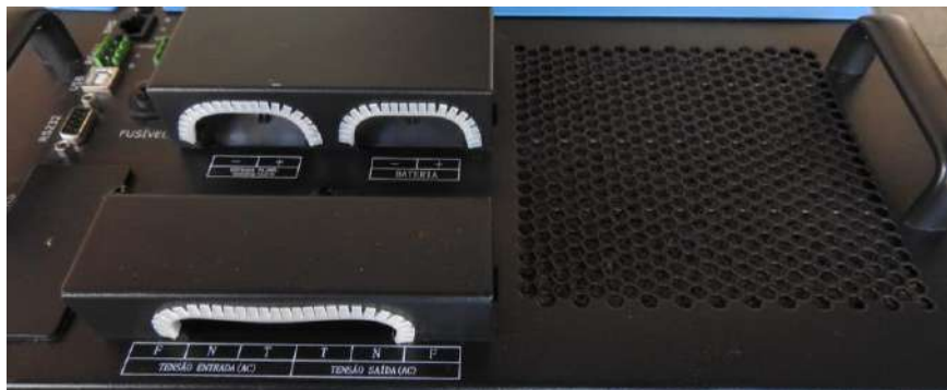
Imagem: entrada dos cabos a esquerda e entrada de ar a direita
